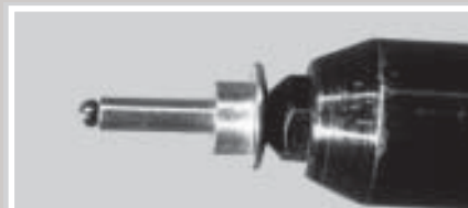
Nýtovačka s nýtem a 6 mm / 0,24" kroužkem pro pevné připojení navlečeným na nýtu
