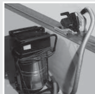
Okružní pila FESTO s vodítkem pro přímé řezání a s odsáváním prachu.
