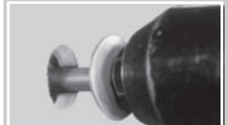
Montáž nýtu v expanzním bodě
